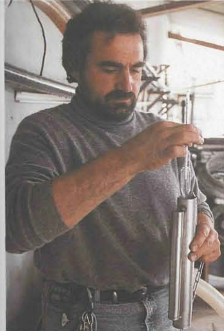
Вверху. Для проверки плотности бродящего сусла, а стало быть, и содержания в нем сахара и спирта в винодельнях регулярно используют гидрометры.
