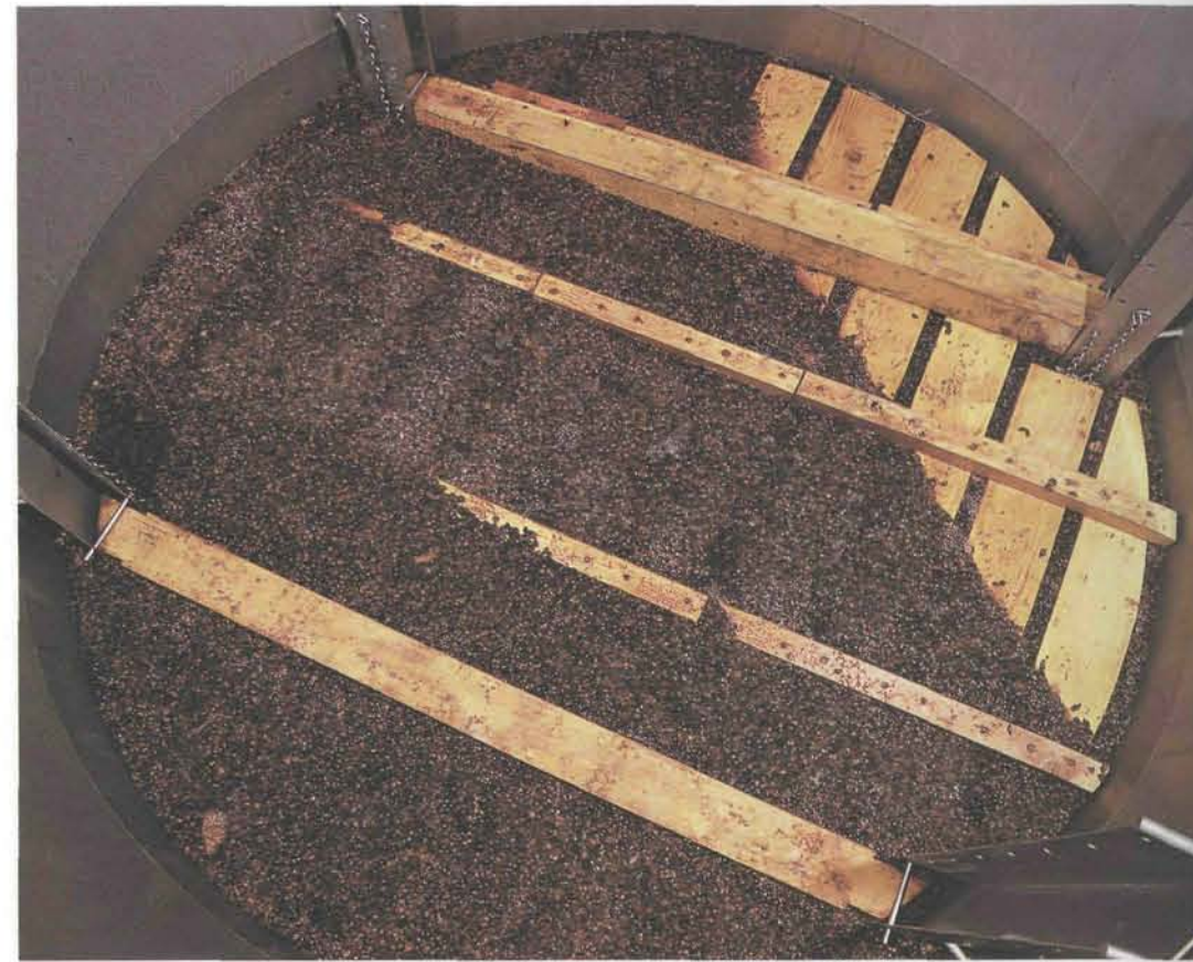
Справа. Альтернативный метод затопления «шапки» Бэйли Карродуса позволяет поддерживать ее во влажном состоянии: в бродильный чан плотно вгоняют дощатую крышку.
